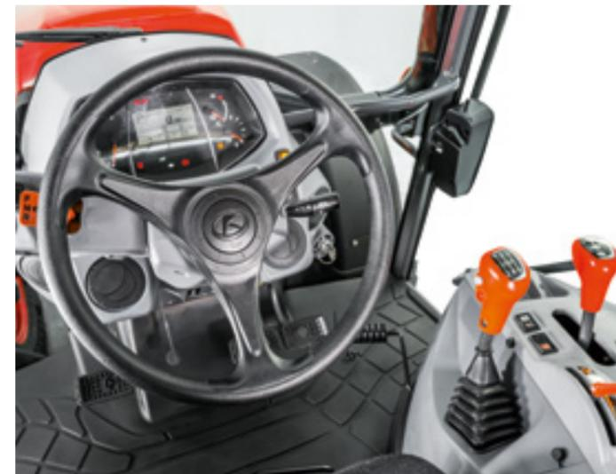
Afin de libérer de l'espace lors de vos entrées et sorties de la cabine, le volant ergonomique peut être incliné vers l'avant. Lorsque vous remontez, vous pouvez le ramener dans sa position initiale par simple pression sur une pédale. Kubota a optimisé l'angle du volant afin de conférer une meilleure visibilité du tableau de bord et pour bénéficier d'une vue dégagée vers l'avant.
