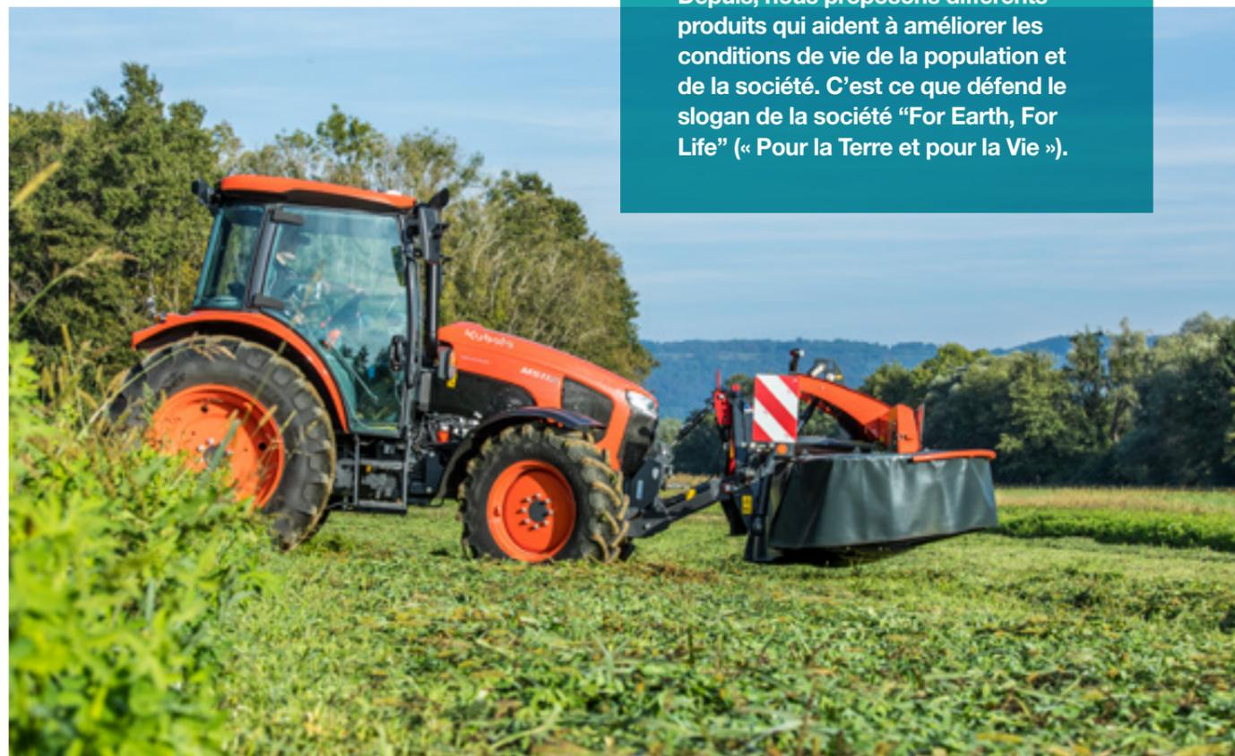
Le pont avant à couple conique, rend le M5002 extrêmement manœuvrable, avec un angle de braquage exceptionnel de 55°. Ce tracteur est donc prédestiné à des travaux dans les espaces restreints. Depuis plus de 30 ans, Kubota utilise les ponts avant à couple conique. Ce type d'engrenages permet d'obtenir un rayon de braquage très court tout en réduisant les entretiens grâce à l'absence de cardans.
